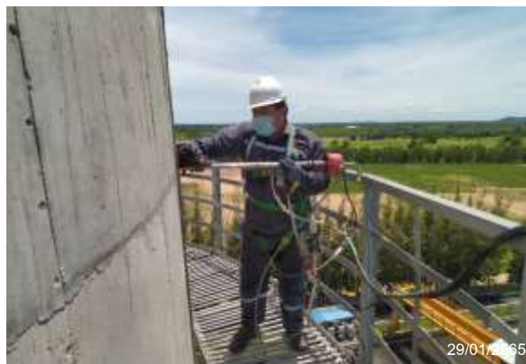
ภาพที่ 3.5.2-1 การตรวจวัดคุณภาพอากาศจากปล่องระบาย
